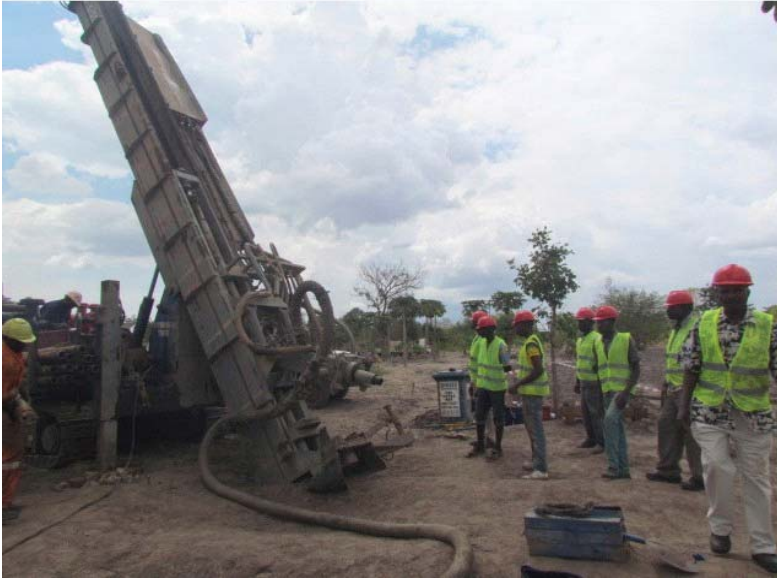
Picha Na.7: Uchorongaji kwa njia ya Reverse Circulation (RC) ukiendelea katika eneo la Itumbi - Chunya
