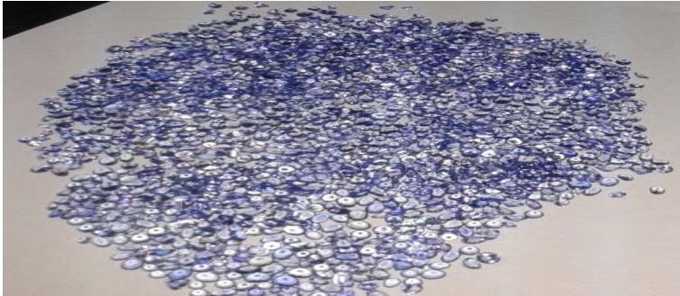
Picha Na. 12(c) : Mawe ya tanzanite yenye ubora wa chini baada ya kung'arishwa kwa mashine ya tumbler na kutobolewa kwa ajili ya kutengenezea vidani.
