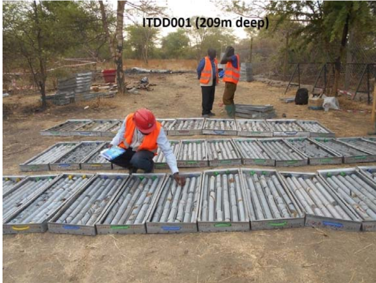
Picha Na.5: Miamba Choronge– Diamond Drilling (DD) iliyotokana na kazi ya utafiti wa madini katika eneo la Itumbi – Chunya.
